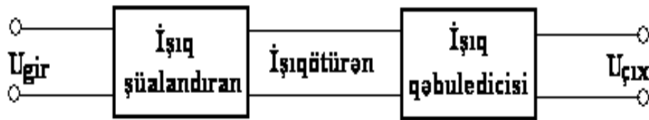
Şəkil 4.32. Daxili optik əlaqəyə malik optronun strukturu
