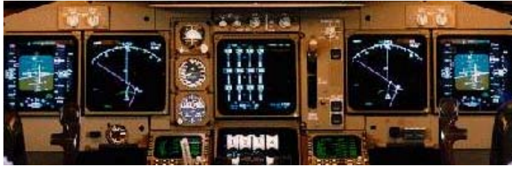
Şək.6.15. Boeing 747 təyyarəsinin cihaz lövhəsində quraşdırılmış CRT (Catode ray tube – Elektron şüa borusu) tipli displeylər.
